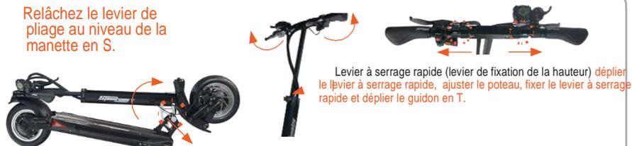
1. Lever le poteau de direction en S (Tube de commande) 2. Déplier le guidon en T après ajustement de la hauteur
