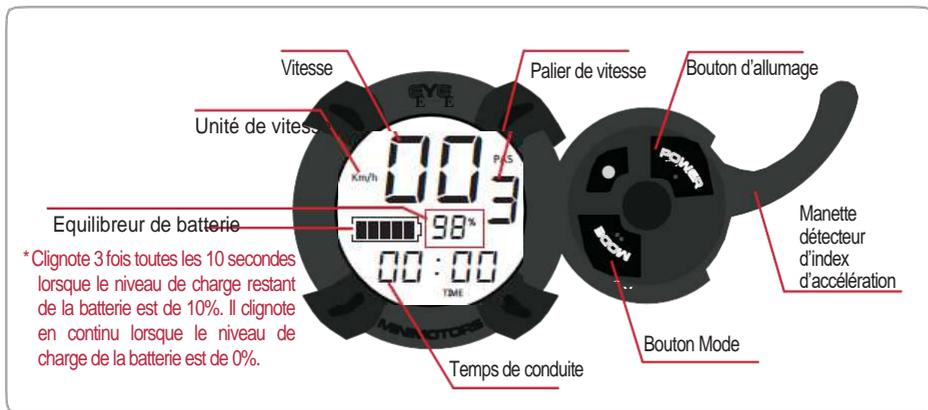
\* Clignote 3 fois toutes les 10 secondes lorsque le niveau de charge restant de la batterie est de 10%. Il clignote en continu lorsque le niveau de charge de la batterie est de 0%.
