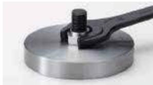
2. Resserrer l'écrou à l'aide d'une clé. Généralement, une force de serrage moyenne suffit.
