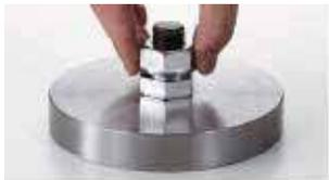
4. Ensuite, serrez le second écrou à la main. A présent, vérifiez que l'écart est suffisant entre le premier et le second écrou puis vérifiez qu'il y a un écart
